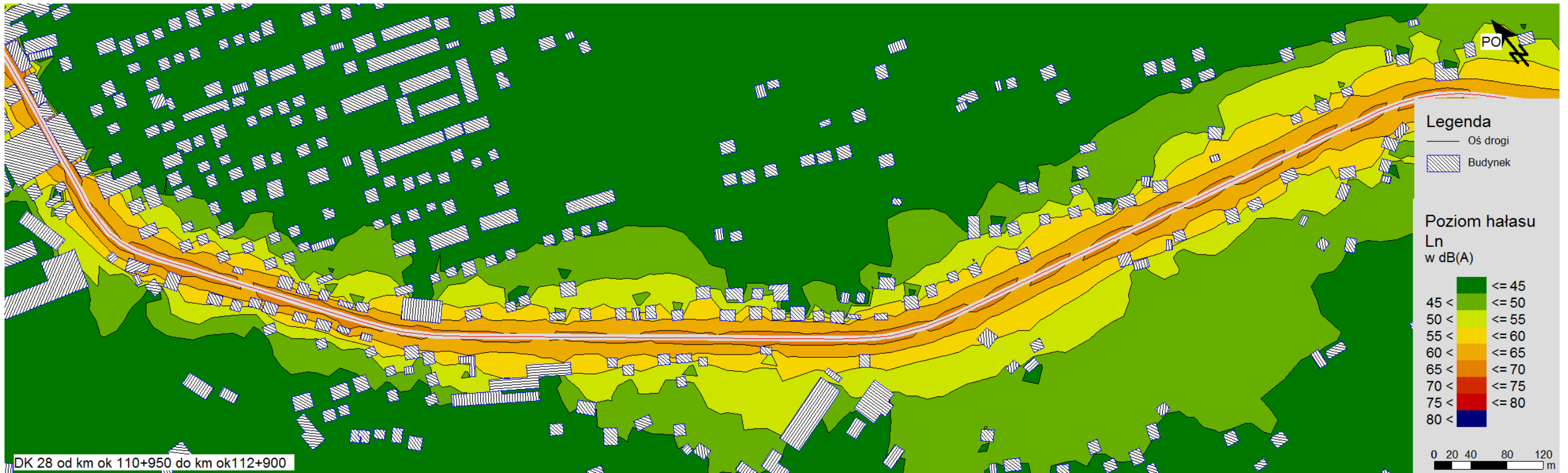
Rys. 26 Efekty zrealizowanych inwestycji. Zasięg hałasu - dla wskaźnika LN - wokół odcinka drogi krajowej nr 28 Limanowa/Przejście pomiędzy km. 110+950 do km 112+900 przed i po modernizacji nawierzchni drogowej..
